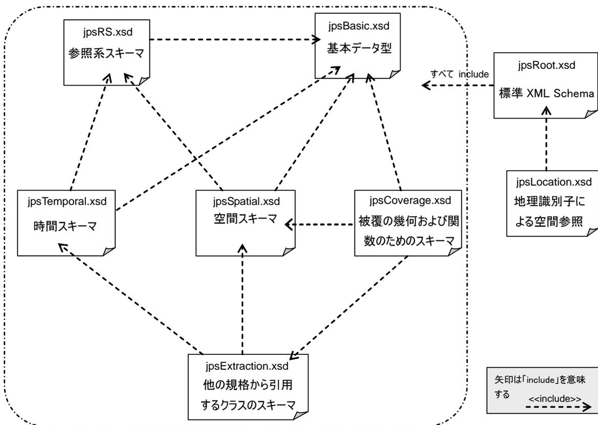
図付 3. 1 標準XML Schemaの構成
